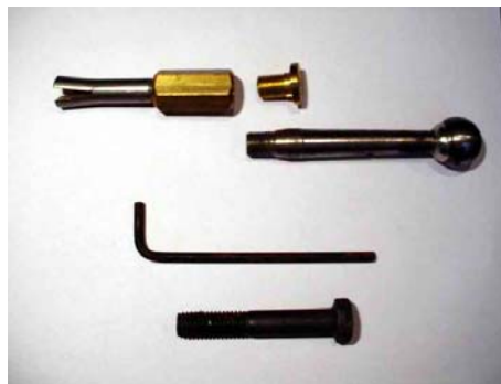
Foto 1. Puntos de control utilizados en las edificaciones. Pernos en acero y bronce para empotrar en estructuras en zonas de alto tráfico y edificaciones históricas (sin riesgo de golpes). Pernos tipo Allen para dejar al aire libre en zonas de bajo tráfico (tienen riesgo de golpes).
